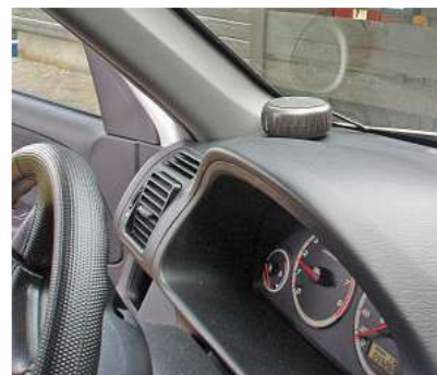
Slik ser ferdsskriveren ut. Boksen sender ut signaler som registreres i en datasentral. Brukeren får tilgang til denne over internett.
